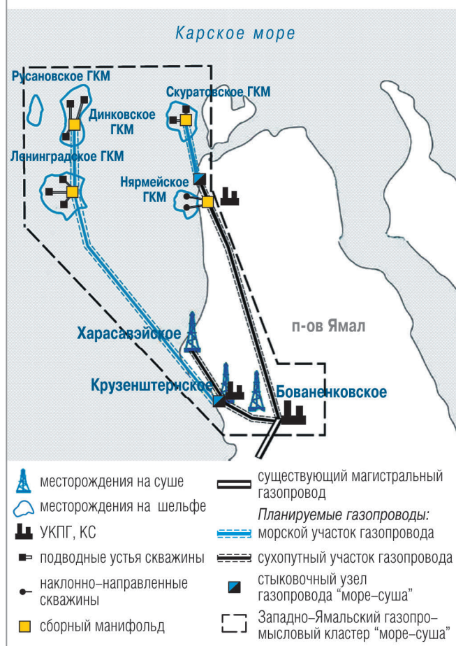
Рис. 2. Концептуальная кластерная схема системы раннего ввода в разработку залежей "сухого" газа ГКМ Ямала и приямальского шельфа Карского моря ("суша-море")
