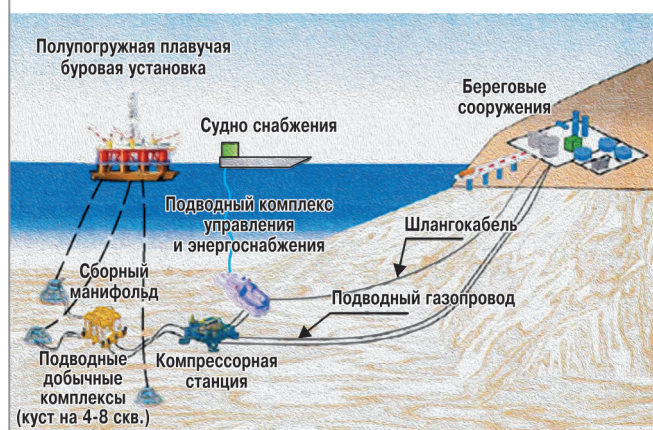
Рис. 4. Предварительная схема обустройства ГКМ в Карском море
